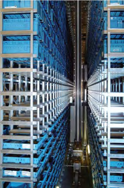
עגורן - במחסן אוטומטי מסוב Mini-Load
