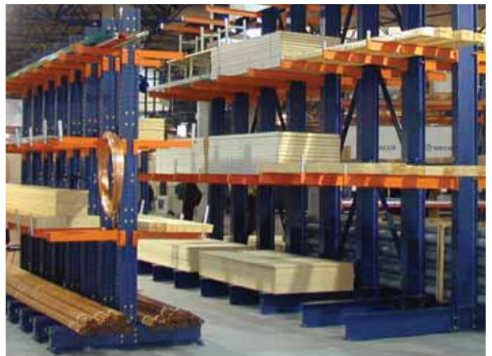
מערכת אחסון מסוג קנטיליבר (Cantilever)
