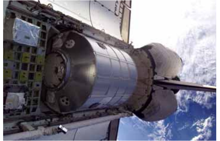
מבט מקרוב על המיכל הלוגיסטי הרב-תכליתי (MPLM) בבטן המעבורת
